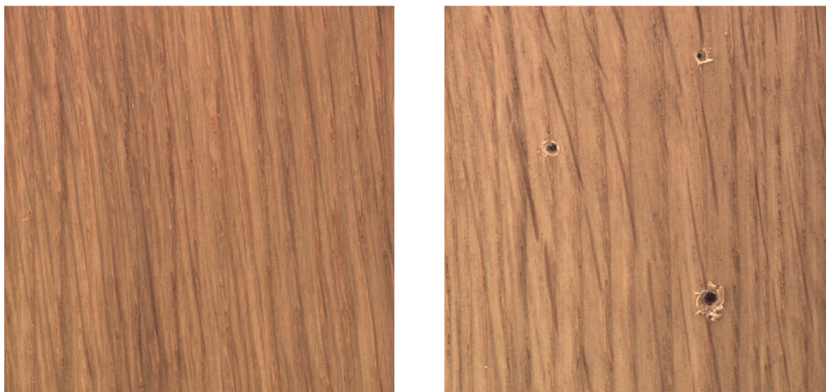
Figure 9 - Image prises du dataset MVtec Wood [13]. À gauche une image sans défaut à droite une image avec un défaut de type trou.
