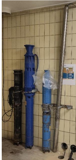
Figure 15 : Anciennes pompes (3 de gauche) et pompe actuelle (à droite)
