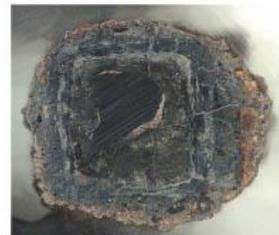
Fig. : Vue au microscope optique d'une coupe transversale d'un clou excavé sur le site d'Avenches (VD).
