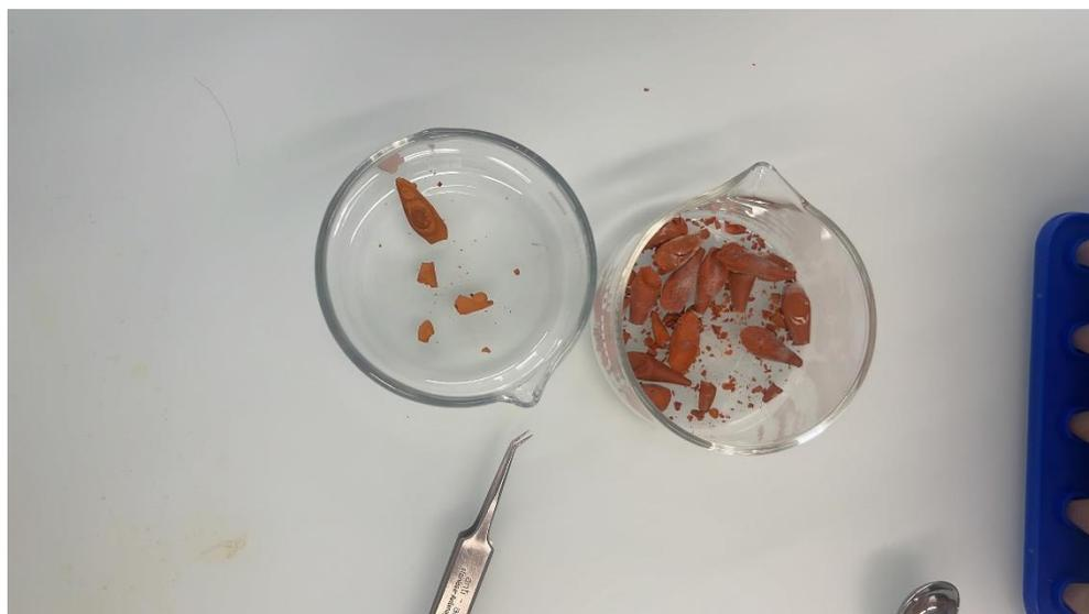
Figure 37 Précipités de lépidocrocite de couleur différente. Gauche plus clair que sur la droite.
