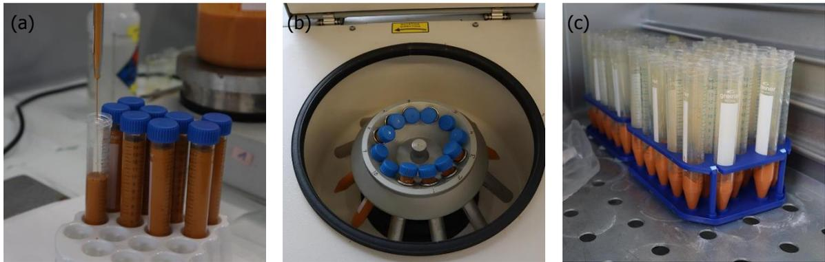
Figure 35 Rinçage et séchage de la lépidocrocite (a) mise en éprouvette du soluté (b) éprouvettes dans la centrifugeuse (c) séchage final du précipité.
