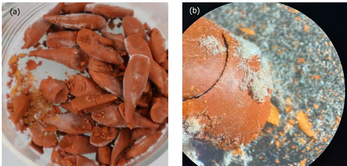
Figure 36 Efflorescences sur les précipités de lépidocrocite (a) à la sortie des éprouvettes (b) sous microscope binoculaire.
