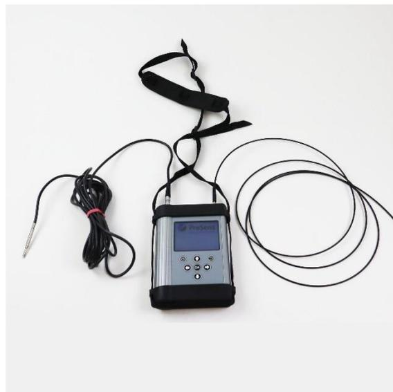
Figure 32 Appareil de mesure de consommation d'oxygène PreSens.
