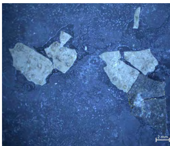
Fig. 104 : test adhésif, phase 1, Aquazol™200 à 8% (w/w) dans isopropanol
