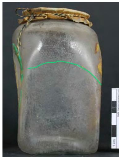
Fig. 27 : LM-2831.4, fissure de type II en vert, sur le côté et sans point d'impact.
