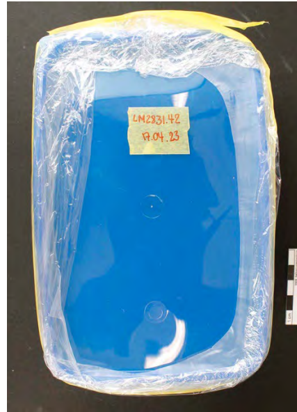
Fig. 121 : test COV, scellage du couvercle du contenant et indication de la date et n° de couvercle
