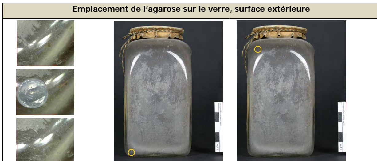
Fig. 92 : mesures pH, emplacement de l'agarose sur le verre
