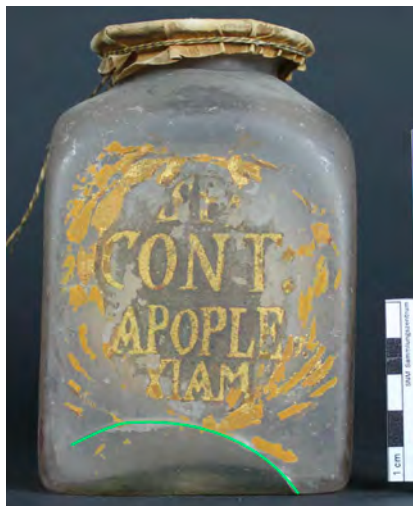
Fig. 26 : LM-2831.11, fissure de type I en vert, sous le pied
