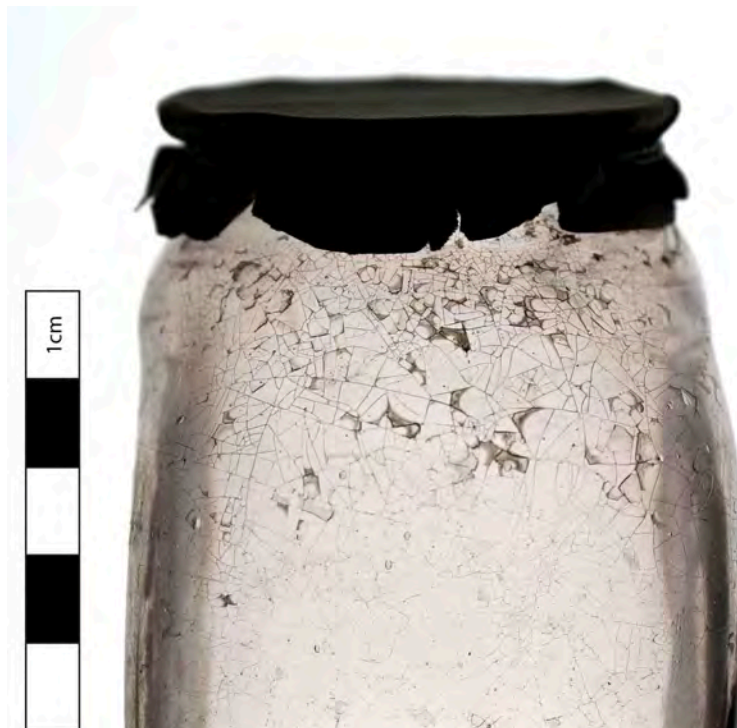
Fig. 31: LM-2831.28, vue par lumière transmise des microfissurations et délamination au niveau des épaules
