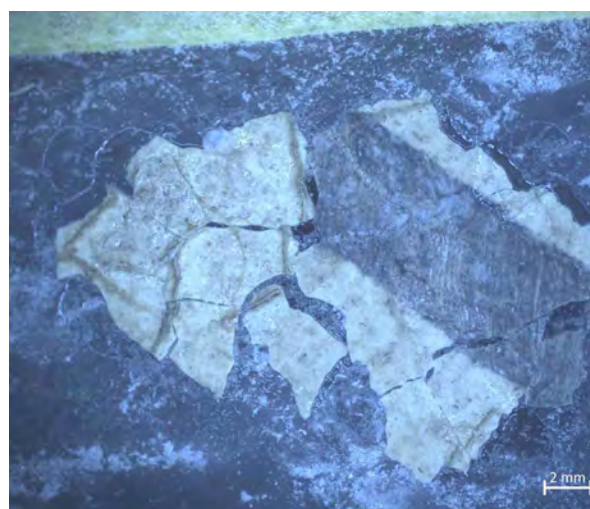
Fig. 105 : test adhésif, phase 1, Aquazol™500 à 15%(w/w) dans éthanol
