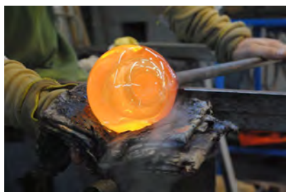
Fig. 11 : la paraison est centrée sur la canne © Atelier-Musée du Verre de Trélon
