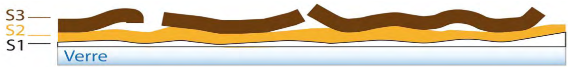
Schéma 4 : exemple illustré de soulèvements de la couche colorée entre les strates S3 et S2.
