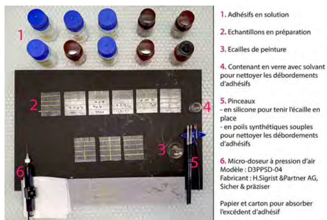
Fig. 102 : test de l'adhésif, outils utilisés pour la préparation des échantillons, sans le nébuliseur
