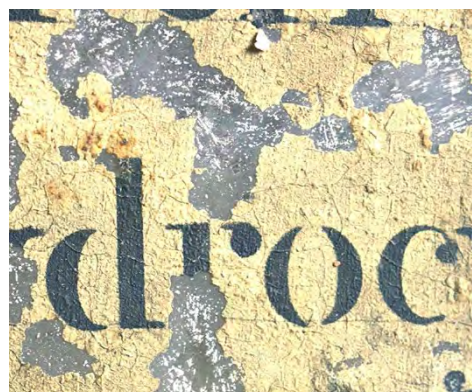
Fig. 30 : LM-2831.32, efflorescences cristallines blanches entre le verre et la CP
