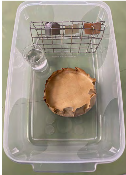
Fig. 120 : test COV, exemple de disposition des différents éléments dans le contenant
