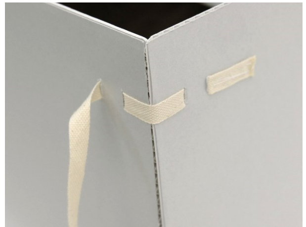
Fig. 68 : Système de fermeture des parois des boîtes
