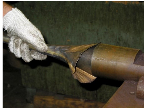
Fig. 26 : Mise en forme du pavillon par martelage
