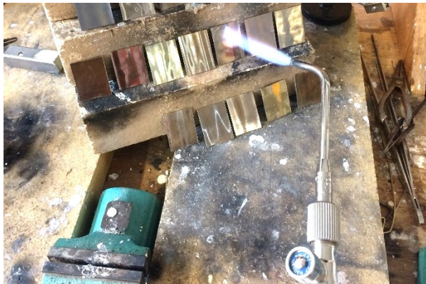
Fig. 61 : Recuite des coupons Argent 925
