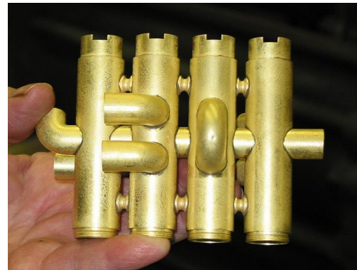
Fig. 29 : Logements pour quatre pistons et logement pour quatre coulisses assemblées par brasure
