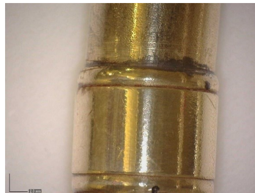
Fig. 30 : Traces technologiques visibles (brasure pour joindre tube et tube de logement de l'embouchure) sur un objet du HMB. N° Inventaire 2004.220. Agrandissement 15x
