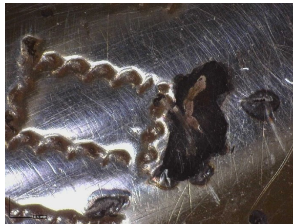
Fig. 6 : Lacune dans le vernis provoquant un ternissement local, N° Inv. 2004.218. Agrandissement 60x
