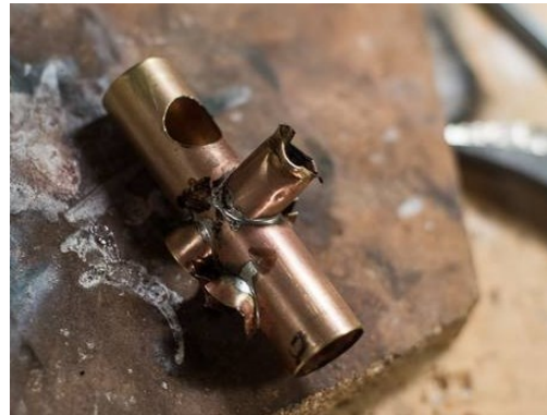
Fig. 28 : Bouchons venant d'être brasés au piston
