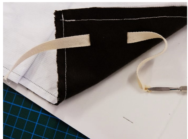
Fig. 70 : Système de fixation du Pacific Silvercloth aux boîtes
