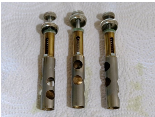
Fig. 23 : Exemple de pistons désassemblés d'un instrument non patrimonial
