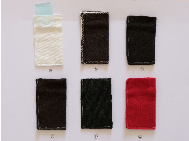
Fig. 59 : Pochettes prêtes pour le test. Coton et papier Brillant® (1), Pacific Silvercloth® (2), Pacific Silvercloth® doublé avec du Tyvek® (3), Flexzorb® (4), Marischael® (5), Robbe & Berking® (6)
