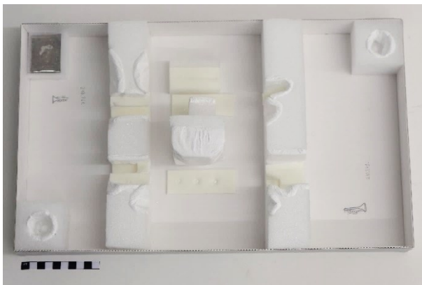
Support en carton cannelé et logements en mousse PE
