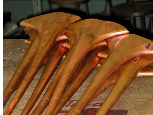
Fig. 25 : Tubes mis en forme par pliage à partir d'une plaque de métal
