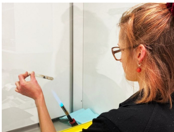
Fig. 49 : Pyrolyse d'un échantillon de matériau
