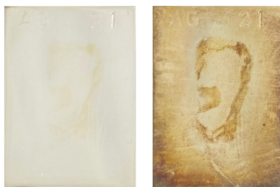
Fig. 14 : Tache présente sur la surface d'un coupon en Argent 925 avant test à gauche et son influence sur l'évolution du tarnissement à droite.
