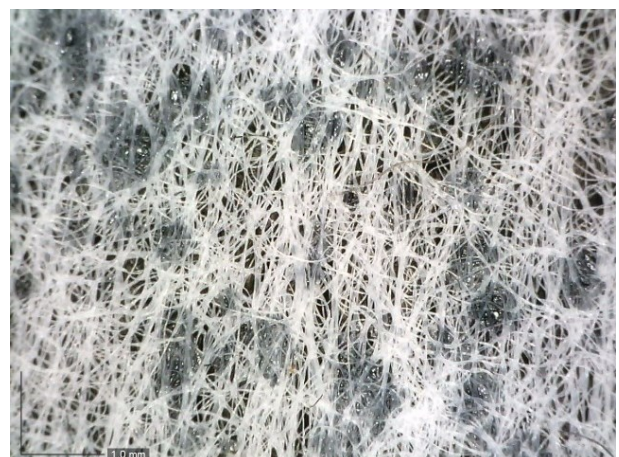
Fig. 56 : Doublage du tissu Floxzorb®, agrandissement 50x.
