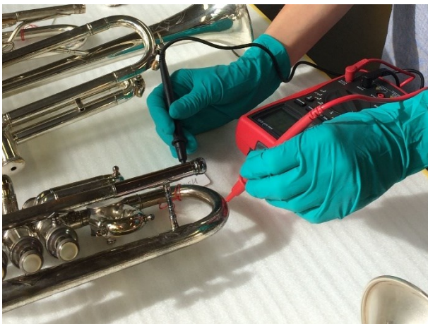
Fig. 5 : Test de conductivité réalisé pour mettre en évidence la présence ou non d'un vernis
