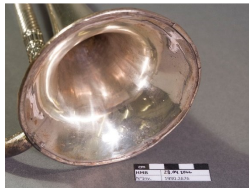
Fig. 27 : Traces technologiques visibles (rabat de la matière sur le bord du pavillon) sur un objet du HMB. N° Inventaire 1980.2676.
