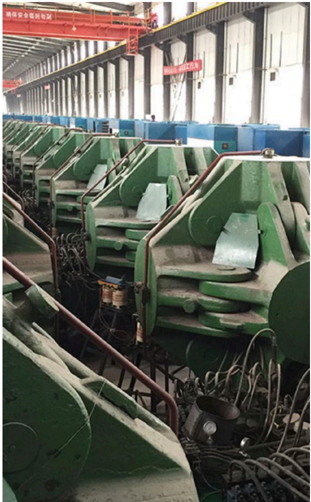
Figure 19 : Machines pour le procédé de la haute pression - haute température (HPHT).
