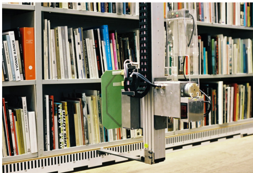
Figure 33 : Bras robotique d'inventaire continu
