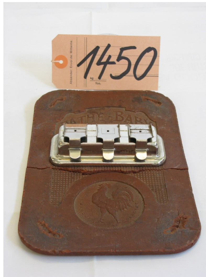
Figure 31 : Colleuse en métal pour films 9.5mm
