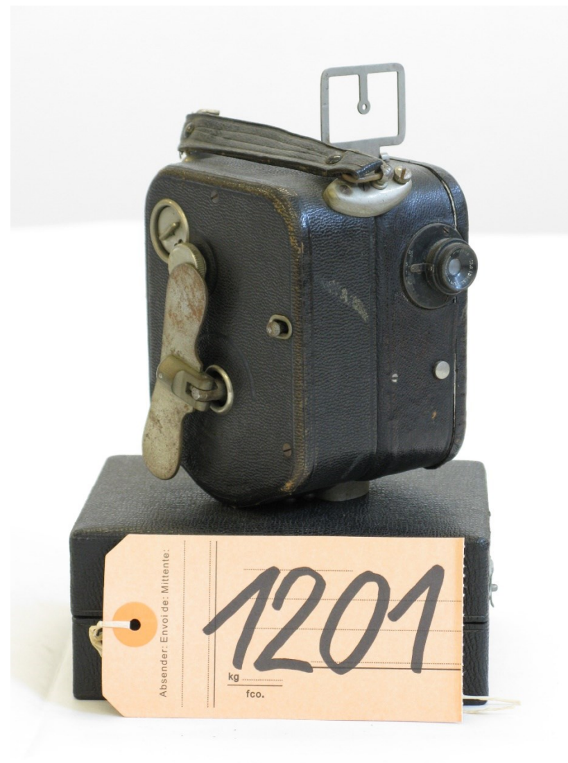
Figure 25 : Caméra Pathé-Baby à système Motrix
