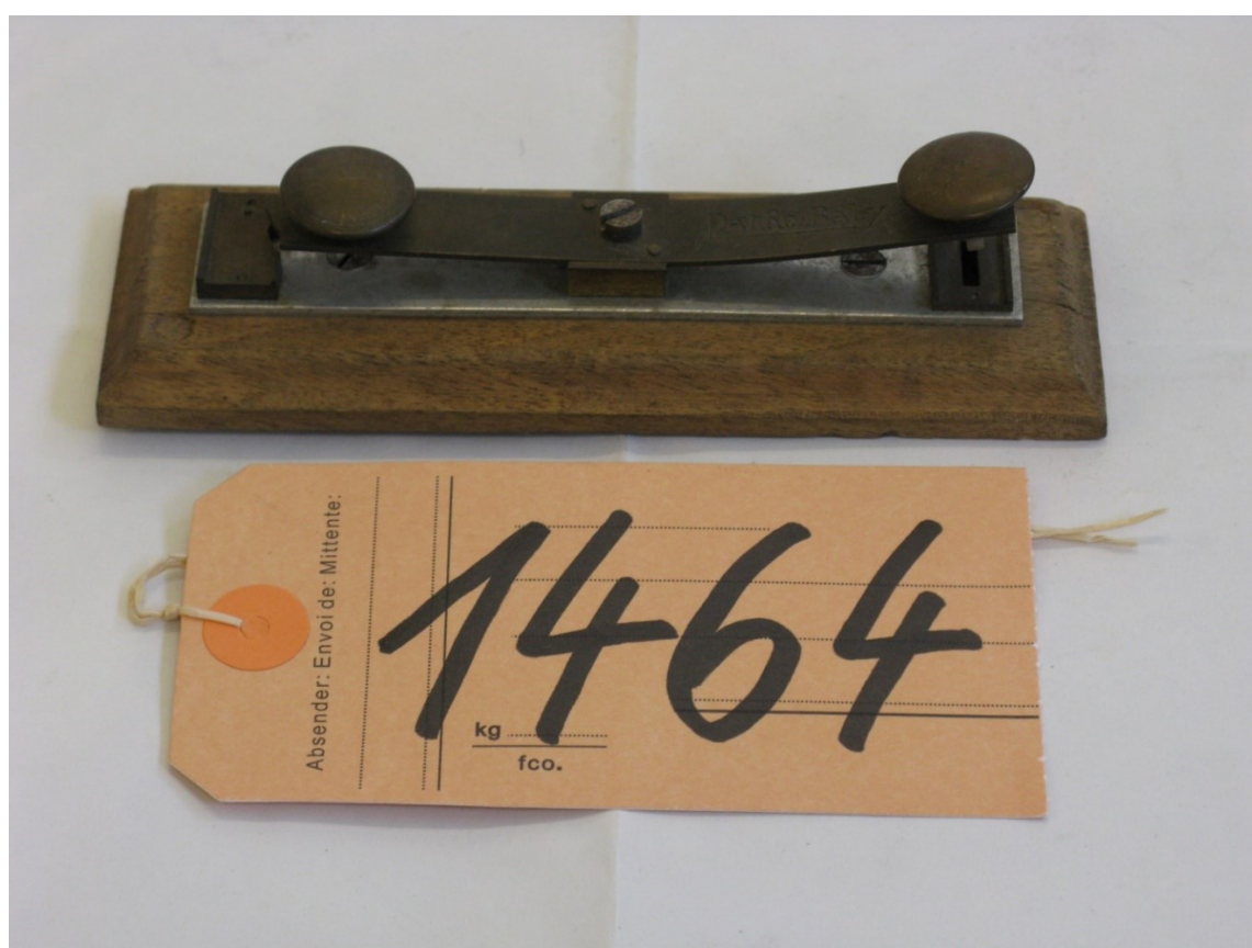
Figure 29 : Outil à encocher les films 9.5mm
