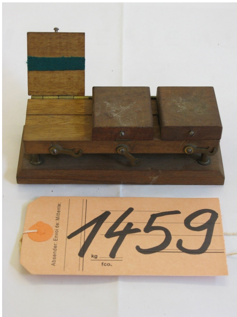
Figure 30 : Colleuse en bois pour films 9.5mm
