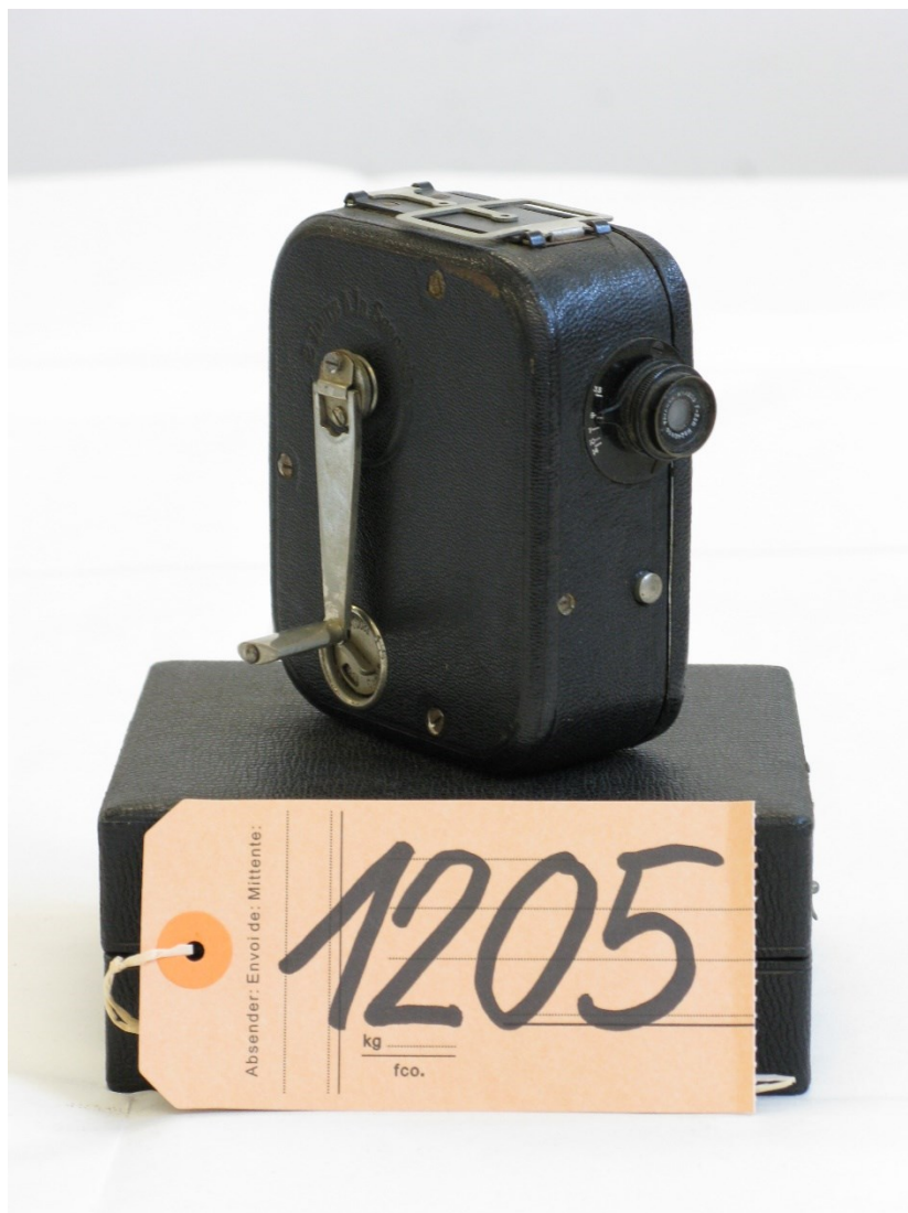
Figure 24 : Caméra Pathé-Baby à manivelle
