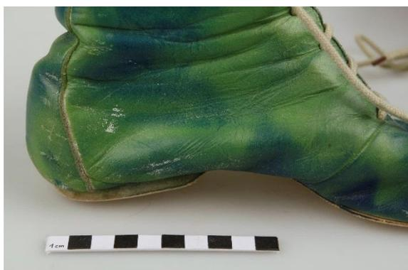
Fig. 110 : Chaussures, courbure et déformation de la semelle
