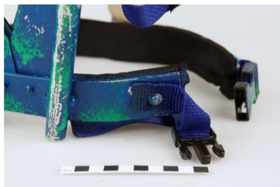
*Fig. 51 : Harnais, système d'attache de boucles à déclenchement*
