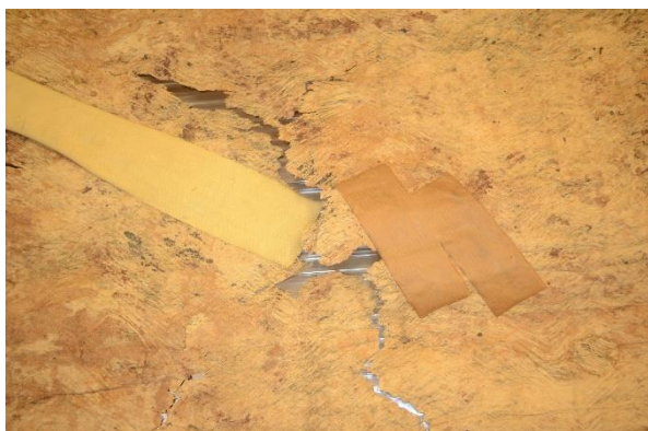
Figure 108 : Déchirure à côté des consolidations.
