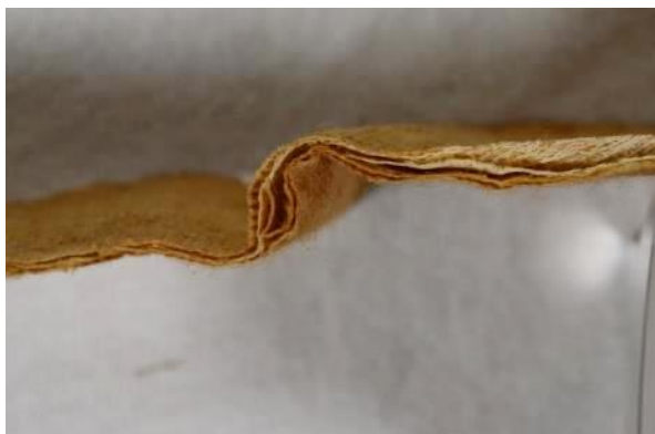
Figure 188 : Délamination du bord de MI/1481.
