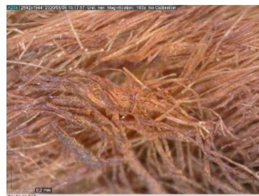
Figure 78 : Apparence des fibres de tapa colorées par la corrosion (grossissement 180x).
