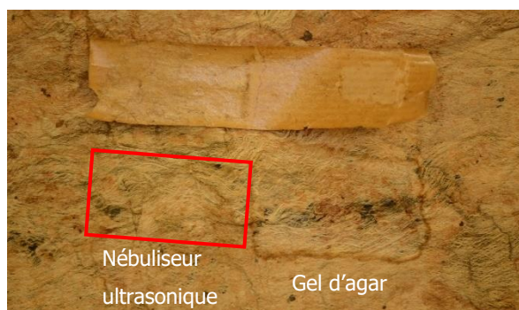
Figure 140 : Résultat obtenu avec le nébuliseur ultrasonique en comparaison avec le gel d'agar.
