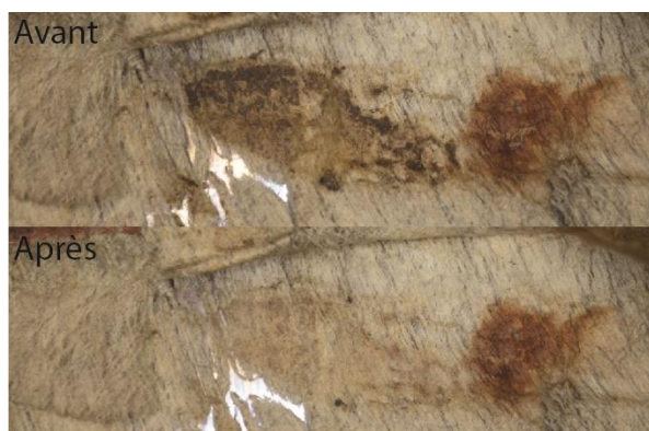
Figure 131 : Efficacité du traitement à l'acétate d'éthyle sur une tache kaki.
