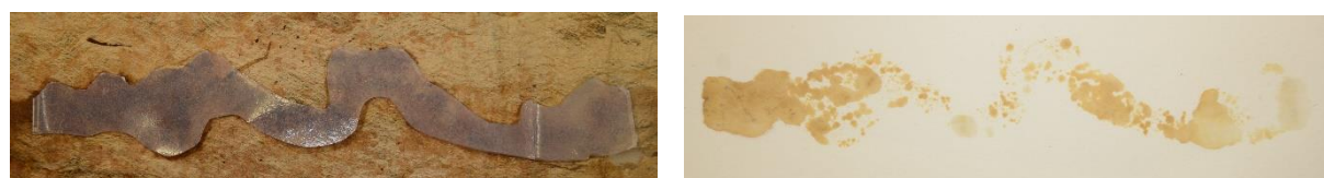
Figure 153 : Gel découpé et buvard placé en dessous après application.
