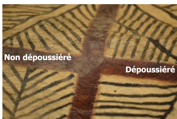
Figure 110 : Test de dépoussiérage avec pinceau doux et aspiration.
