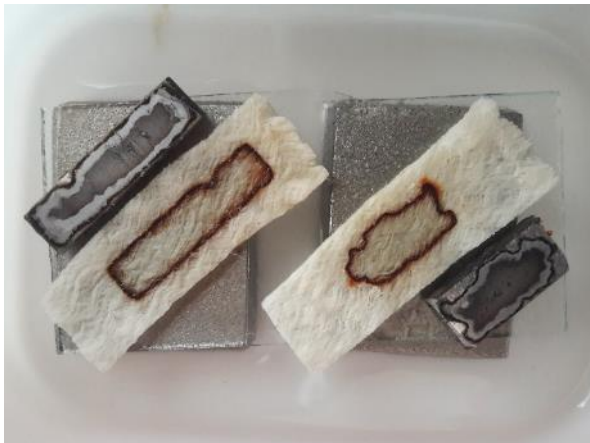
Figure 213 : Dépôts de corrosion ferreuse sur les morceaux de tapa mouillés (gauche) et secs (droite).
