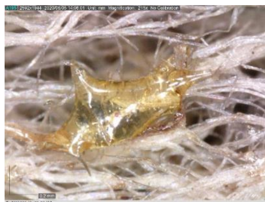
Figure 99 : Aspect de la nitrocellulose (grossissement 215x).
