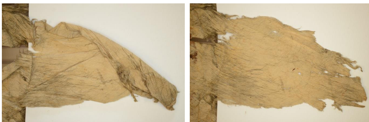
Figure 135 : Avant et après remise en forme à l'aide du nébuliseur ultrasonique.
