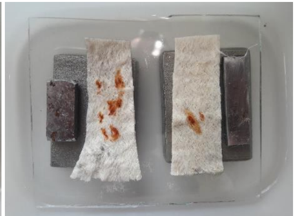
Figure 213 : Dépôts de corrosion ferreuse sur les morceaux de tapa mouillés (gauche) et secs (droite).
